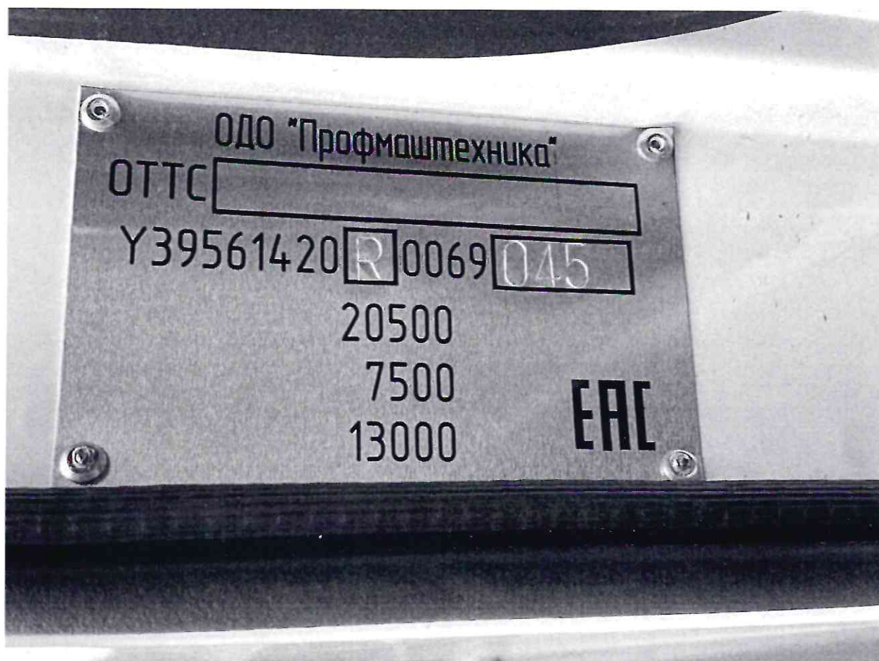
Рис. 3 Таблички с идентификационным номером изделия (VIN), показателями масс
