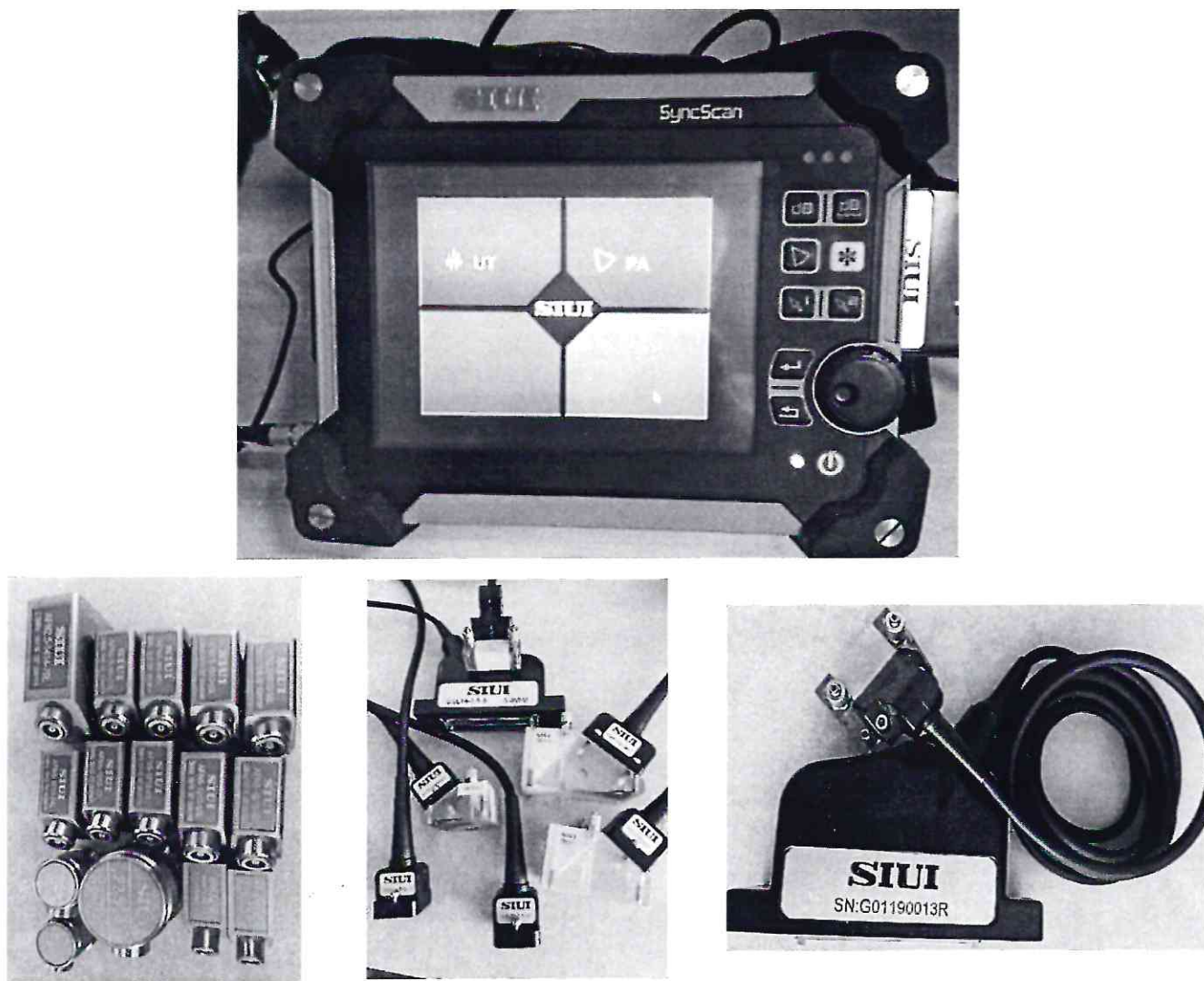
Рисунок 1.1 – Фотографии общего вида модификаций SyncScan PA16:64PR/UT, SyncScan PA32:128PR/UT2 дефектоскопов ультразвуковых SyncScan (электронный блок дефектоскопа и преобразователи ультразвуковые)
