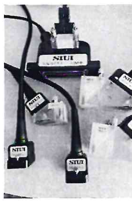
Рисунок 1.2 – Фотографии общего вида модификаций SyncScan PA16:64PR/TOFD/UT, SyncScan PA32:128PR/TOFD1/UT2, SyncScan PA32:128PR/TOFD2/UT2 дефектоскопов ультразвуковых SyncScan (электронный блок дефектоскопа и преобразователи ультразвуковые)
