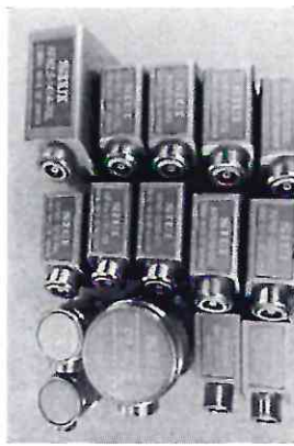
Рисунок 1.2 – Фотографии общего вида модификаций SyncScan PA16:64PR/TOFD/UT, SyncScan PA32:128PR/TOFD1/UT2, SyncScan PA32:128PR/TOFD2/UT2 дефектоскопов ультразвуковых SyncScan (электронный блок дефектоскопа и преобразователи ультразвуковые)
