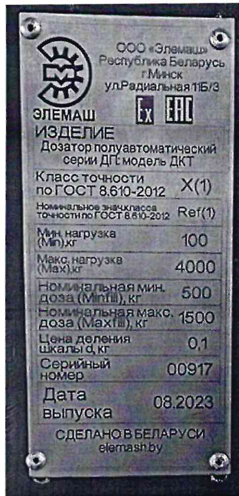
Рисунок 1.3 – Фотографии маркировки дозатора полуавтоматического, серии ДП: модель ДКТ № 00917
