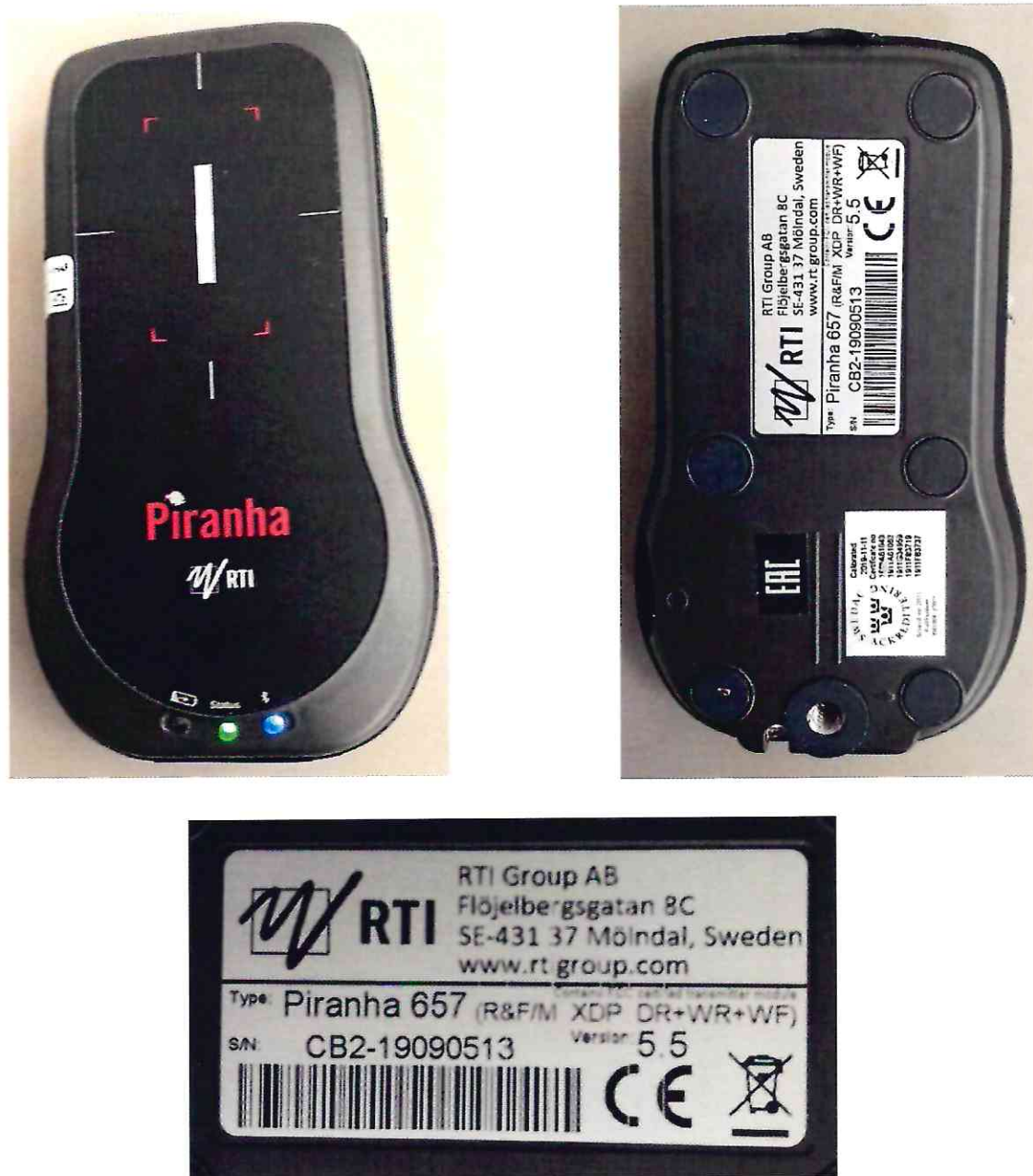
Рисунок 1.1 – Фотографии общего вида и маркировки базового блока дозиметра Piranha 657 № CB2-19090513
