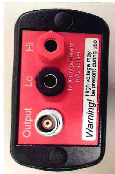
Рисунок 1.3 – Фотографии общего вида и маркировки внешнего детектора MAS-1B № DM5-19030108
