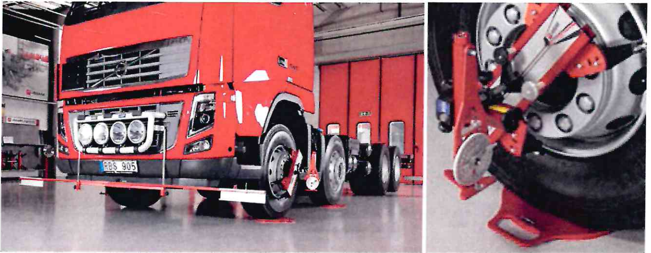
Рисунок 1.1 – Фотография общего вида станда для измерения углов установки колес и положения осей грузовых транспортных средств JOSAM Laser AM
