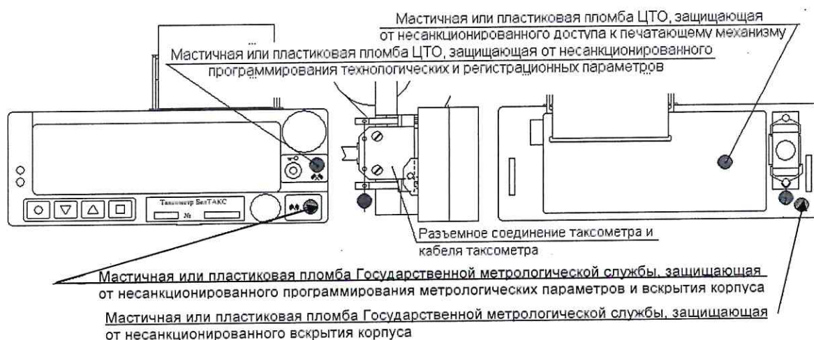
Рисунок 3.1 – Схема расположения пломб на передней и задней панелях таксометра БелТАКС
