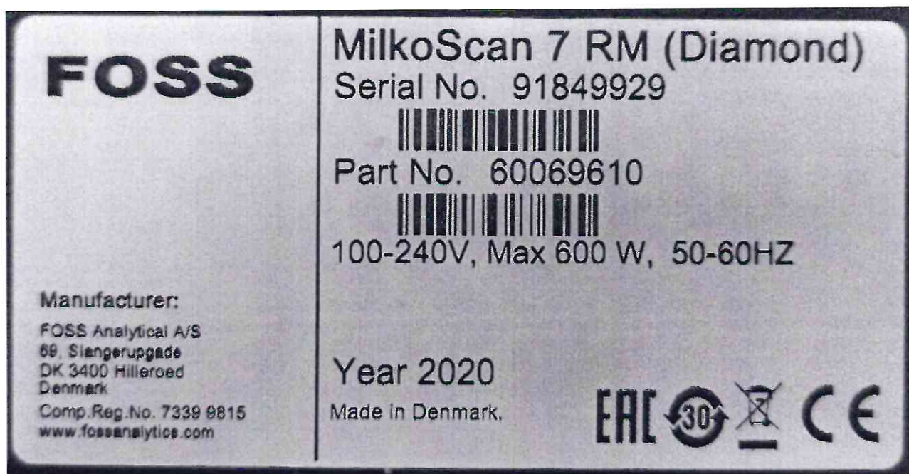
Рисунок 1.2 – Фотография маркировки анализатора молока MilkoScan 7 RM № 91849929
