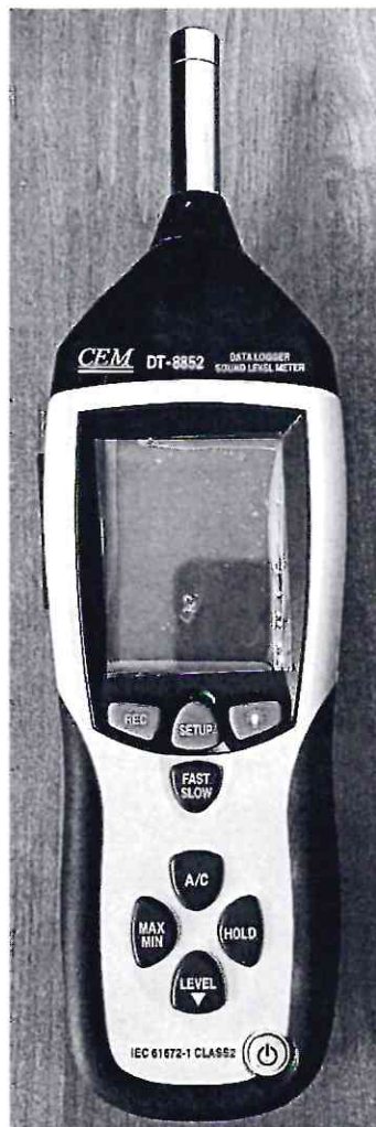
Рисунок 1.1 – Фотография общего вида измерителя уровня звука DT-8852 № 150301754
