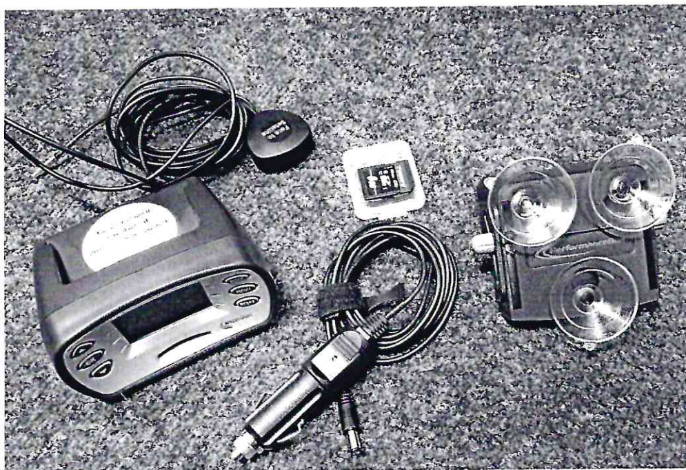
Рисунок 1.1 – Фотография общего вида прибора измерительного Racelogic Performance Box № 5025834
