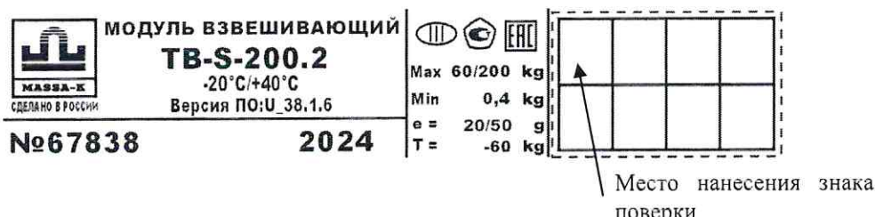
Рисунок 8 – Маркировка модуля взвешивающего и место нанесения знака поверки
