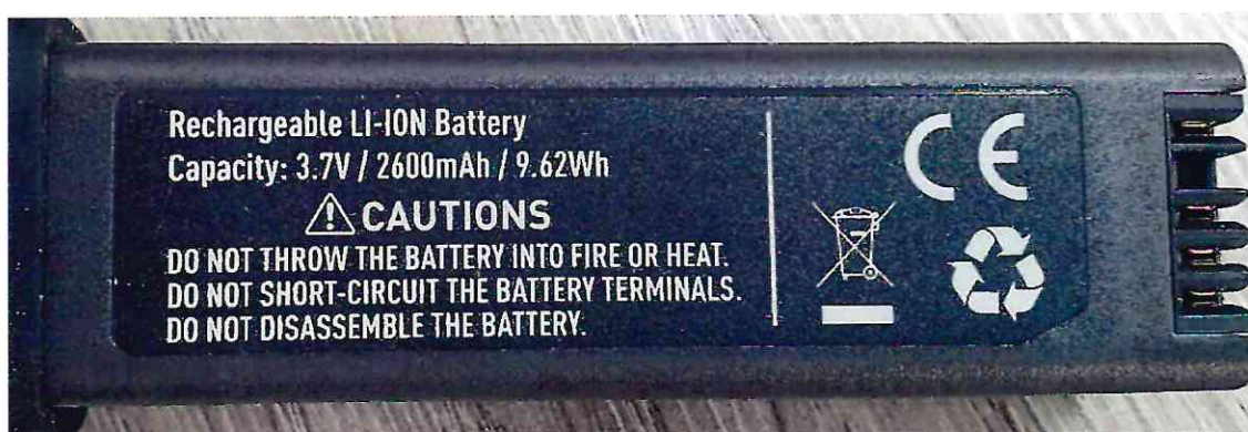
Рисунок 1.3 – Маркировка литий-ионной аккумуляторной батареи тепловизора DT 9887 № 240225902
