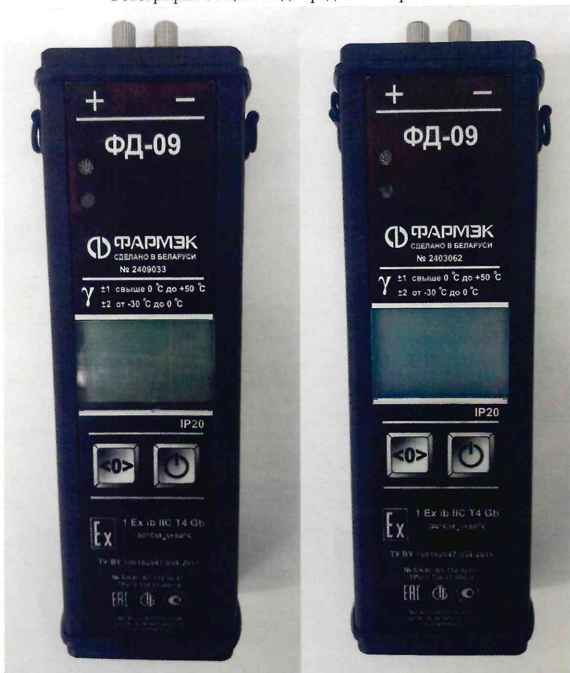
Рисунок 1.1 – Фотографии общего вида и маркировки измерителей давления газа ФД-09 (изображение носит иллюстративный характер)
