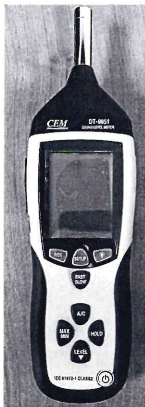
Рисунок 1.1 – Фотография общего вида измерителя уровня звука DT-8851 № 12044640
