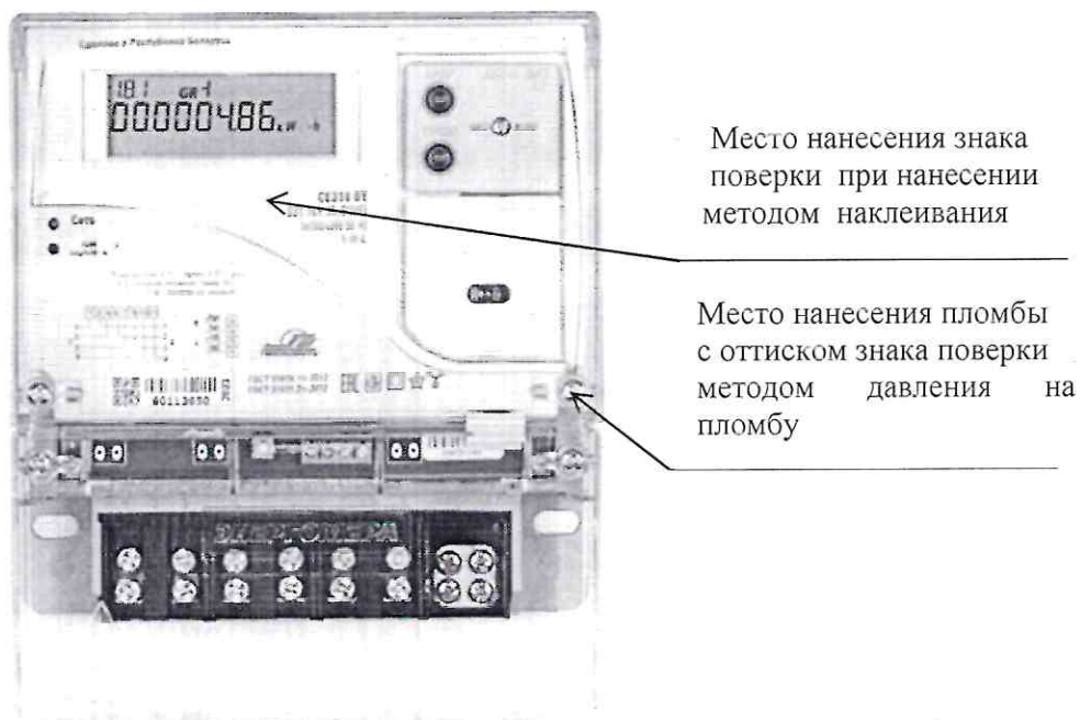
Рисунок 2.2 - Схема (рисунок) с указанием места для нанесения знака поверки на счетчик CE318BY в типе корпуса S31
