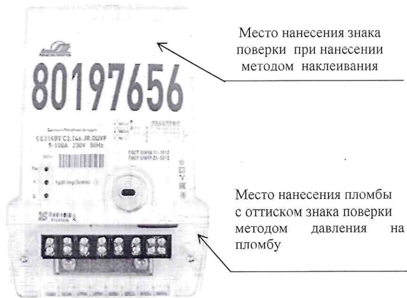
Рисунок 2.3 - Схема (рисунок) с указанием места для нанесения знака поверки на счетчик CE318BY в типе корпуса С3
