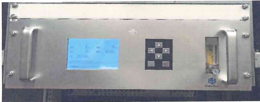
Рисунок 1.1 – Фотография анализатора газа Gasboard-3000Plus
