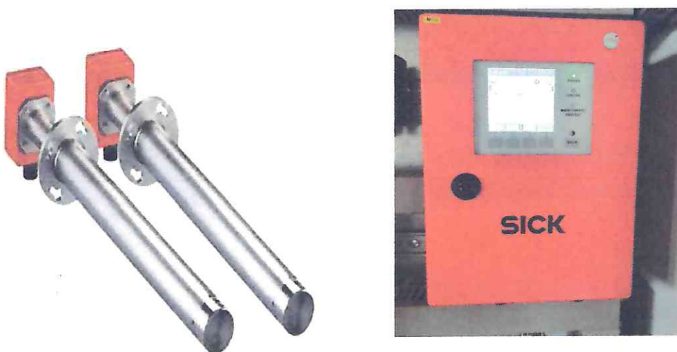
Рисунок 1.2 – Фотография измерителя скорости ультразвукового FLOWSIC100 H
