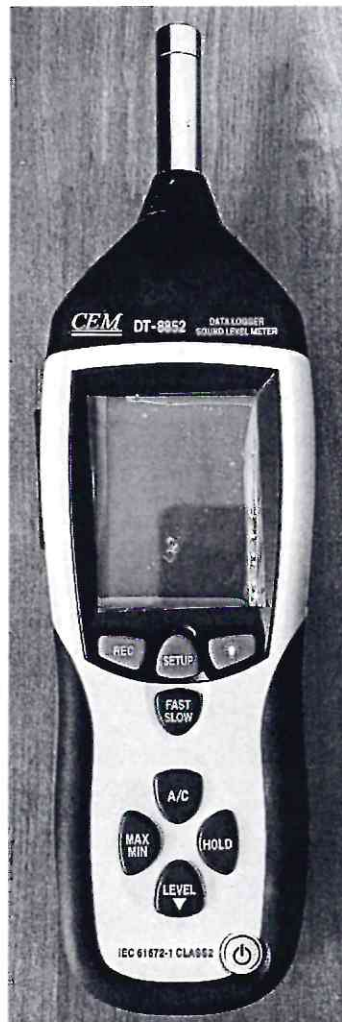
Рисунок 1.1 – Фотография общего вида измерителя уровня звука DT-8852 № 150301779
