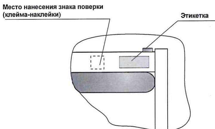
Рисунок 2 – Место нанесения знака поверки (клейма-наклейки)
