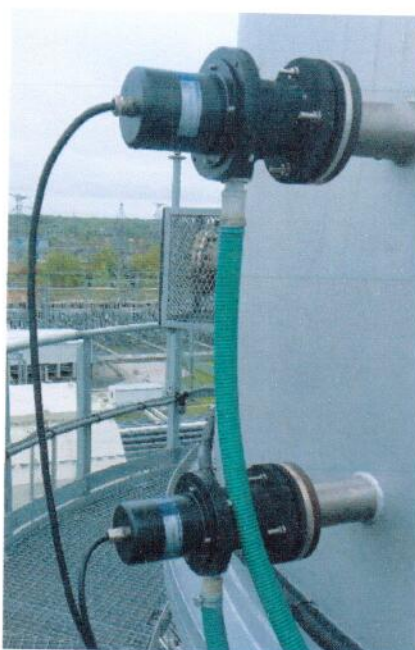
Рисунок 1.5 – Фотография измерителя скорости газовоздушных потоков инфракрасного VCEM 5100
