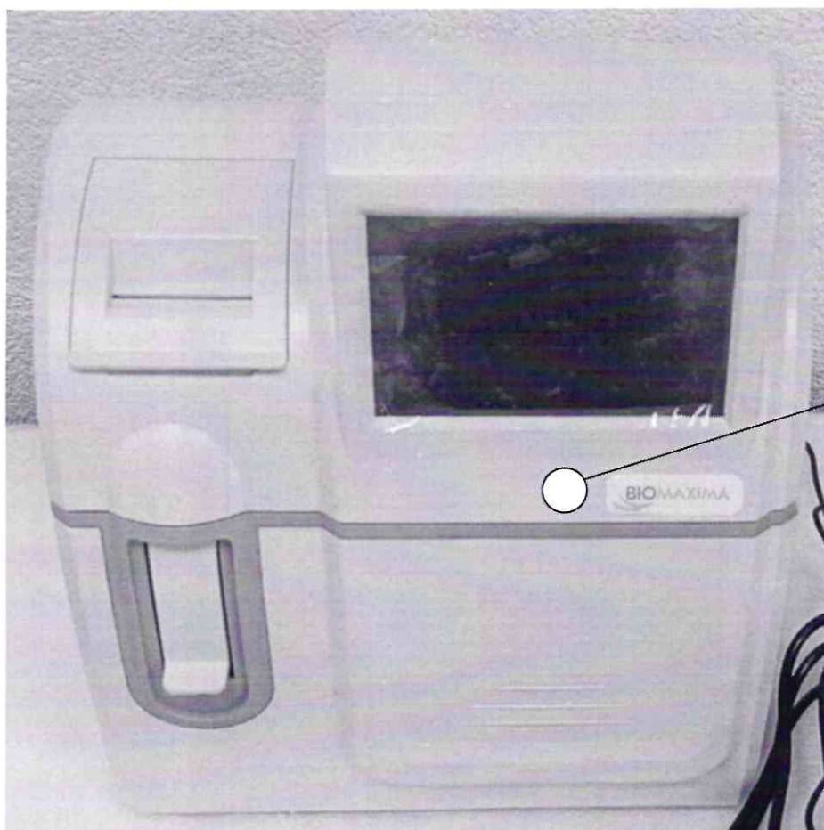
Рисунок 2 – Схема с указанием места для нанесения знака поверки анализаторов электролитов ВМ
