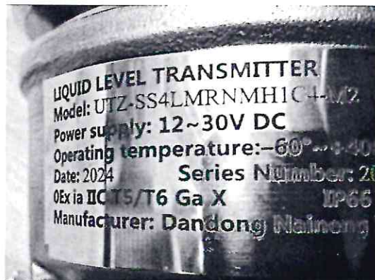
а) маркировочная табличка на корпусе торсионной трубки уровнемера
