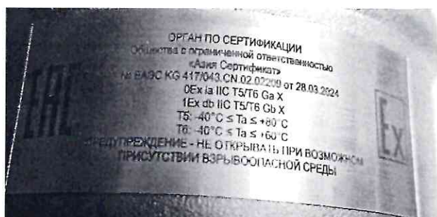
б) маркировочные таблички на электронном преобразователе уровнемера
