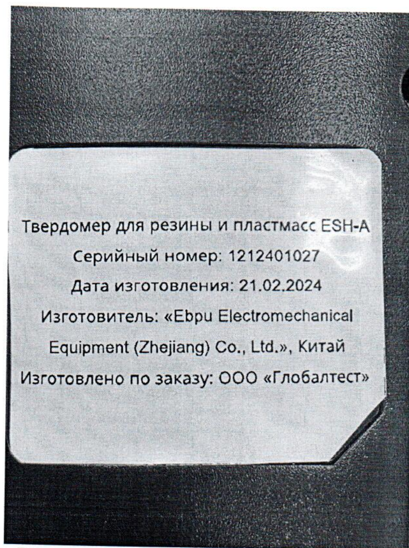
Рисунок 1.2 – Пример маркировка твердомера для резины и пластмасс ESH-A
