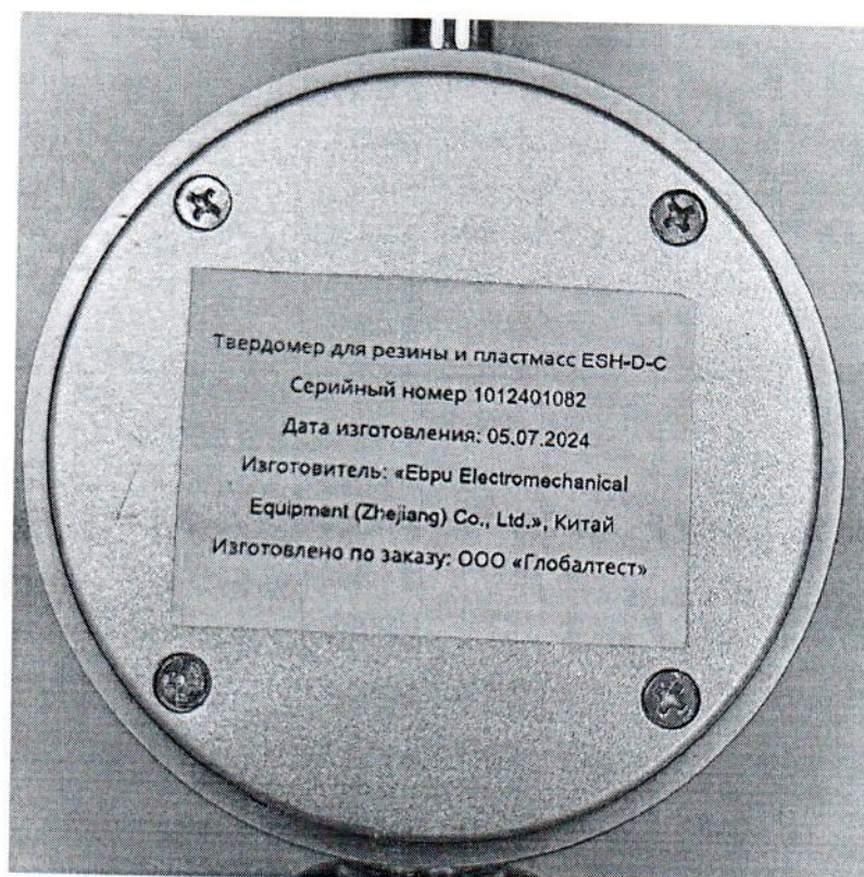
Рисунок 1.3 – Пример маркировки твердомера для резины и пластмасс ESH-D-C
