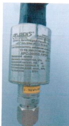
Рисунок 1.3 – Фотография преобразователя давления измерительного APC-2000
