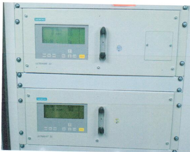
Рисунок 1.1 – Фотография газоанализаторов ULTRAMAT 23
