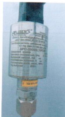
Рисунок 1.3 – Фотография преобразователя давления измерительного APC-2000
