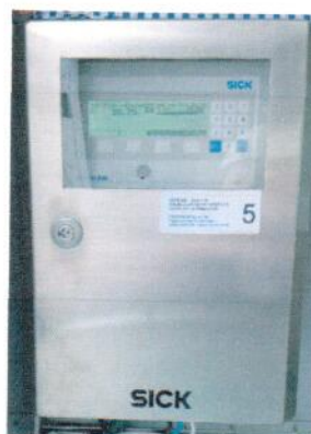
Рисунок 1.2 – Фотография газоанализатора ZIRKOR200
