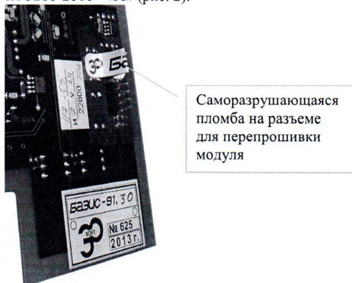
Рисунок 2 - Пломбирование от несанкционированного доступа (фрагмент модуля)
