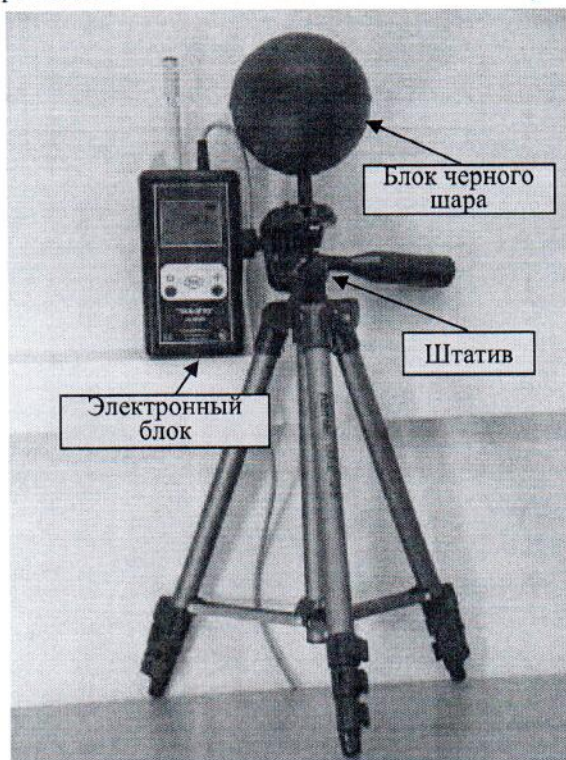
Рис. 1 Вид измерителя ТКА-ИТО
