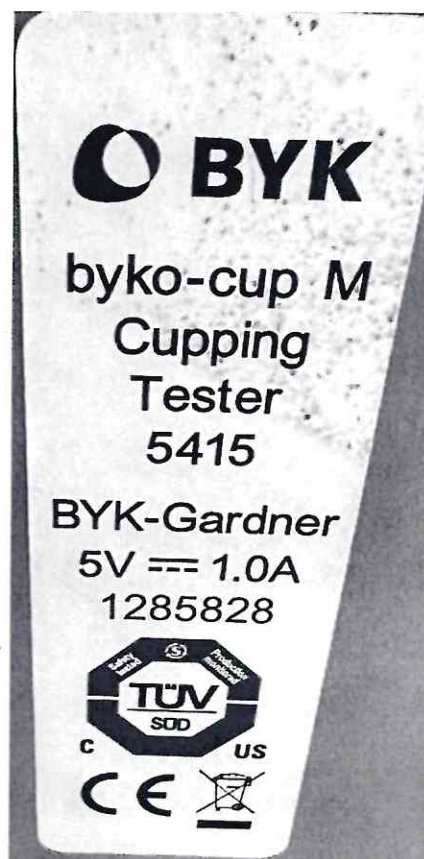
Рисунок 1.2 – Фотография маркировки ручного штампа Эриксона 5415 byko-cup M № 1285828
