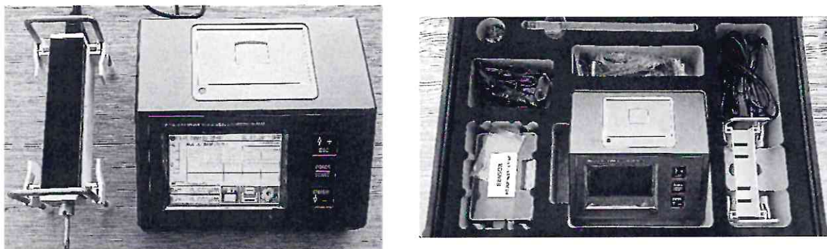
Рисунок 1.1 – Общий вид прибора для измерения параметров шероховатости АГАТ-М3
