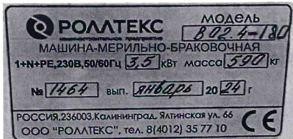
Рисунок 1.2 – Фотография маркировки машины мерильно-браковочной «РоллТекс» модель В 02.4-180 №1464
