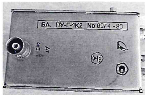
Рисунок 1.4 – Фотографии внешнего вида составных частей и маркировки спектрометра (спектрометрическое устройство СУ-04П ПК в составе: спектрометрический усилитель УИС-02, блок напряжения высоковольтный БНВ-05, блок питания низковольтный БНН-01, предварительный усилитель ПУ-Г-1К2)
