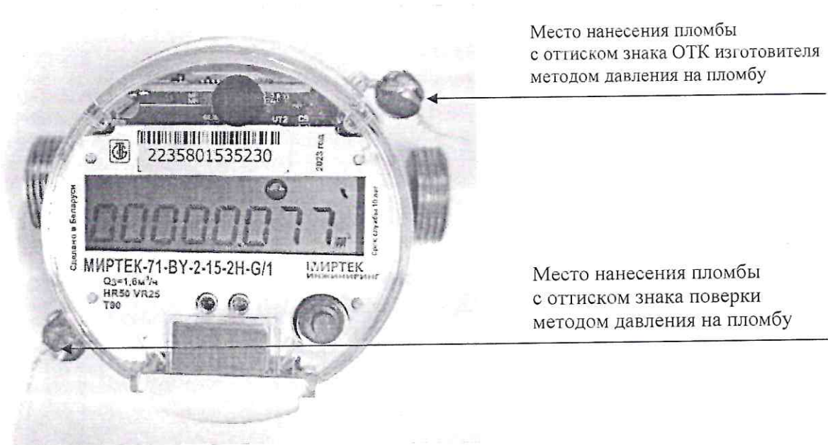
Рисунок 3.1 – Схема пломбировки счетчиков от несанкционированного доступа
