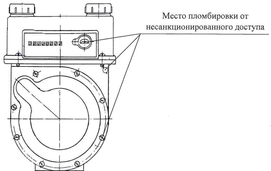
Рисунок 3.1 – Схема пломбировки от несанкционированного доступа
