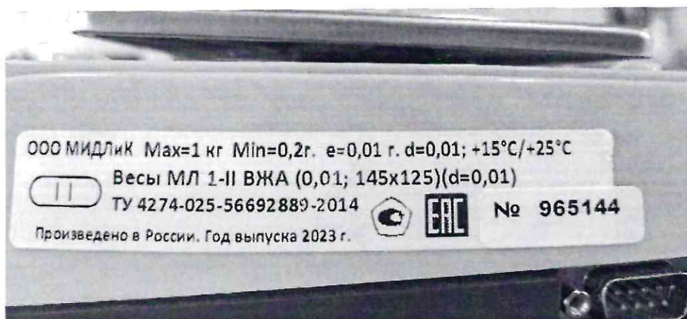
Рисунок 5 – Маркировочная табличка весов (пример) Знак поверки может наноситься на лицевую панель весов в виде наклейки.
