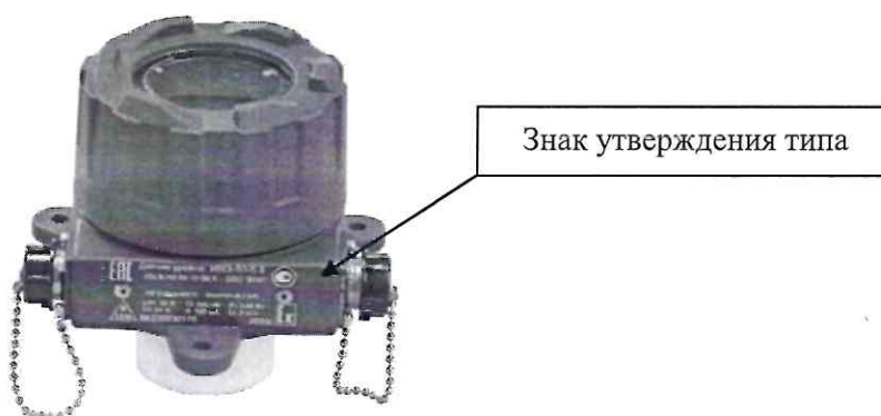
Рисунок 2 – Обозначение места нанесения знака утверждения типа
