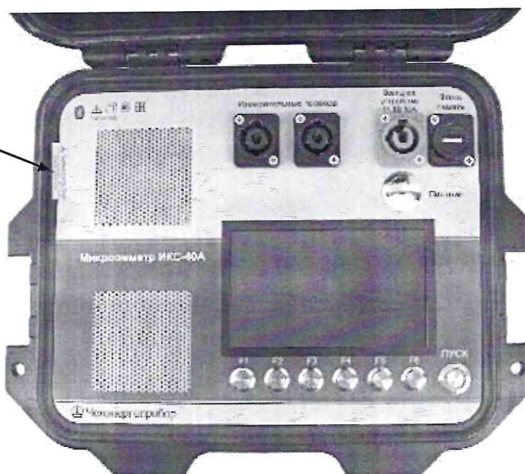
Рисунок 2 – Общий вид микроомметров исполнения ИКС-40А с местом нанесения пломбировочной наклейки (в открытом виде)
