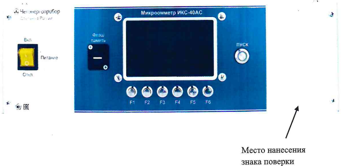
Рисунок 2.2 – Схема (рисунок) с указанием места для нанесения знака поверки исполнения ИКС-40АС
