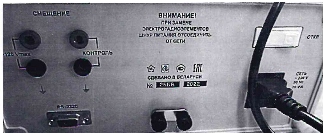
Рисунок 1.2 – Фотография маркировки измерителей иммитанса E7-20 (изображение носит иллюстративный характер)
