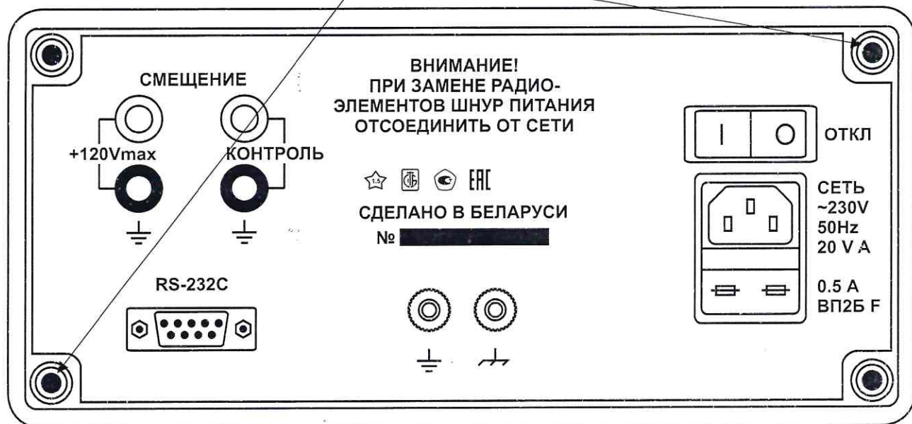
Рисунок 3.1 – Схема пломбировки от несанкционированного доступа
