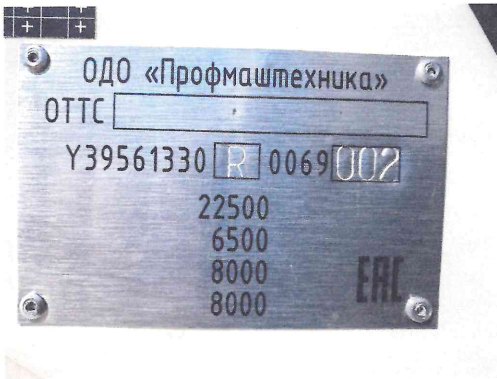
Рис. 4 Таблички с идентификационным номером изделия (VIN), показателями масс
