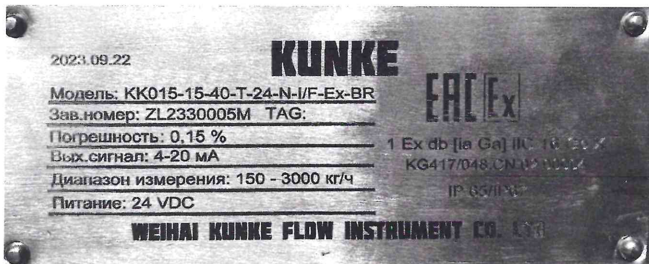
Рисунок 1.2 – Фотография маркировки расходомеров массовых КК
