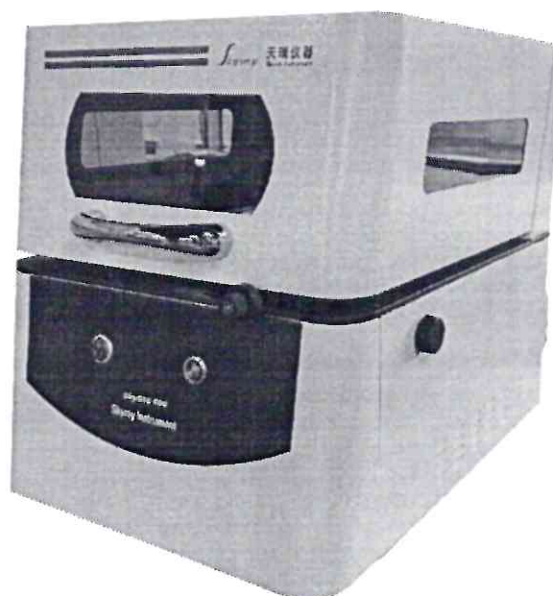
Рисунок 1.1 – Общий вид спектрометра рентгенофлуоресцентного SkyGTE 600
