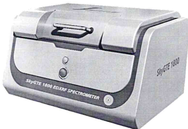
Рисунок 1.2 – Общий вид спектрометра рентгенофлуоресцентного SkyGTE 1800
