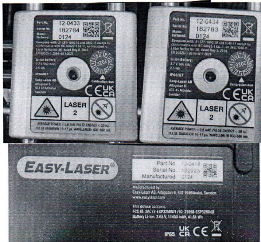
Рисунок 1.2 – Фотографии маркировки лазерной системы центровки валов Easy-Laser E710 № 00000013
