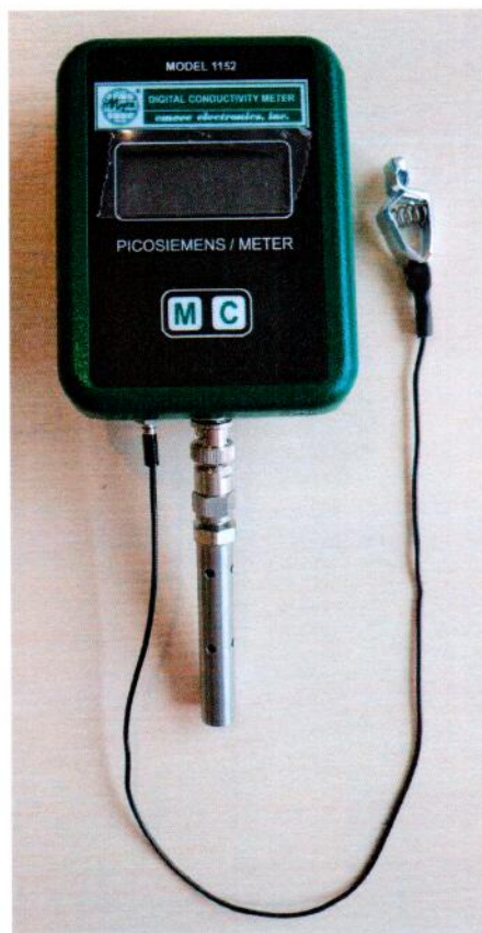
Рисунок 1.1 – Фотография общего вида измерителя удельной электропроводимости углеводородных жидкостей EMCEE 1152 № 230133
