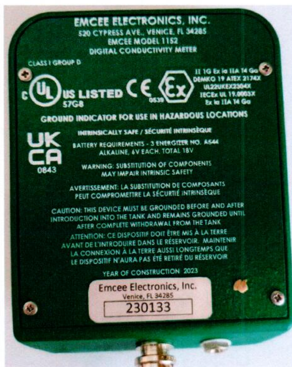
Рисунок 1.2 – Фотография маркировки измерителя удельной электропроводимости углеводородных жидкостей EMCEE 1152 № 230133
