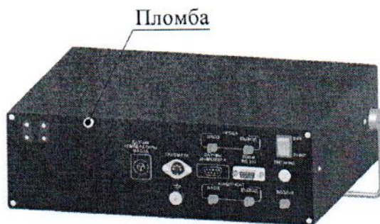
Рисунок 8 – Место пломбирования приборов
