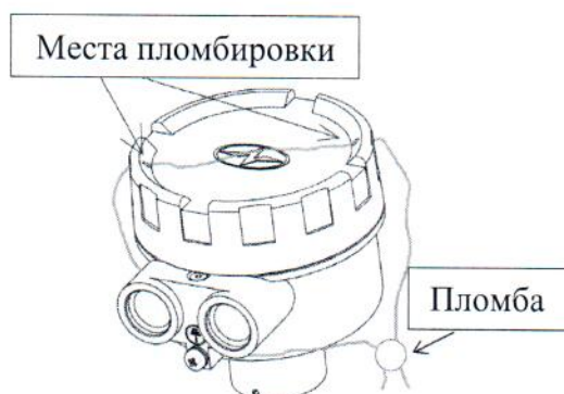
Рисунок 2 – Схема пломбировки от несанкционированного доступа
