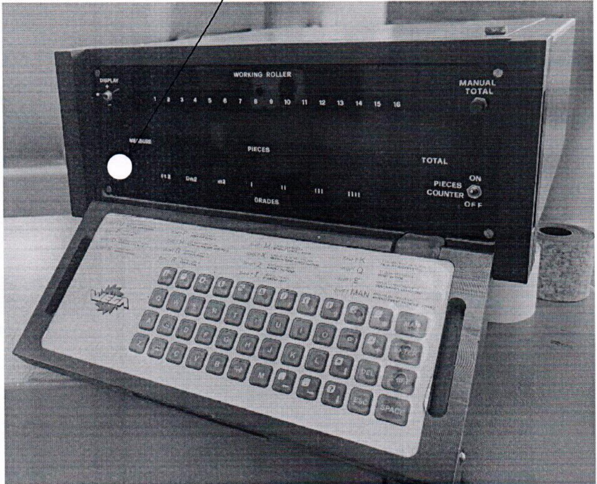
Рисунок 2.1 - Схема (рисунок) с указанием места для нанесения знака поверки машины измерительной NOVA 3 № 0498
