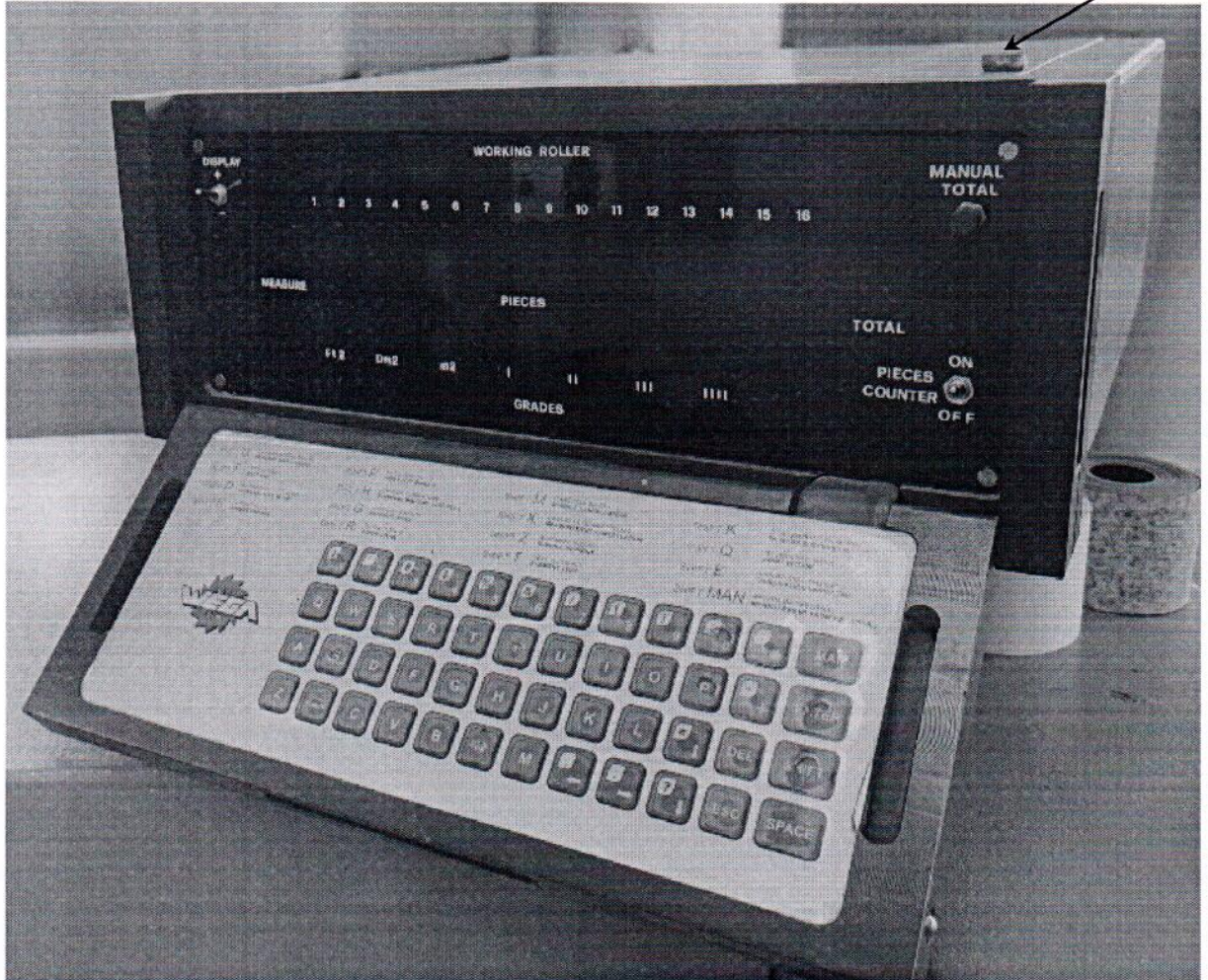
Рисунок 3.1 - Схема (рисунок) пломбировки от несанкционированного доступа машины измерительной NOVA 3 № 0498
