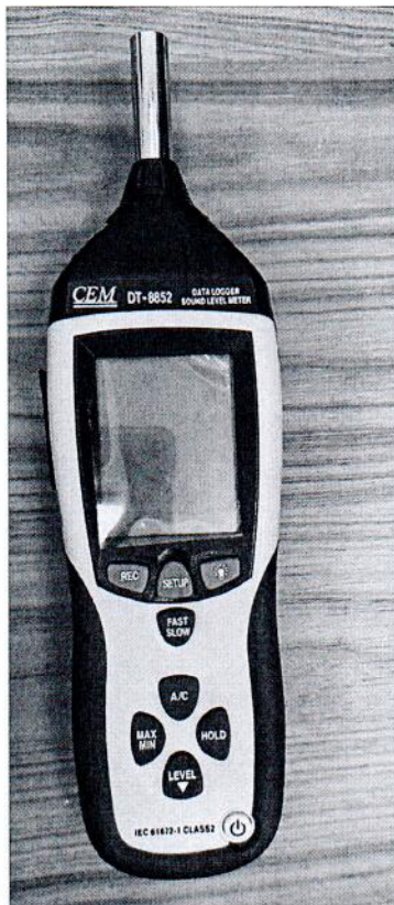
Рисунок 1.1 – Фотография общего вида измерителя уровня звука DT-8852 № 150301764
