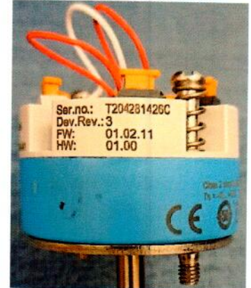
в) Термопреобразователь сопротивления TPR100 № T2043414180 в комплекте с преобразователем температуры измерительным iTEMP TMT82 № T204281426C
