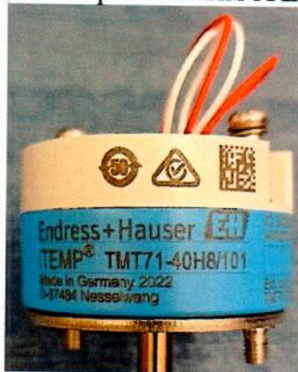
г) Термопреобразователь сопротивления TS111 № T20401143E5 в комплекте с преобразователем температуры измерительным iTEMP TMT71 № T203F31449F
