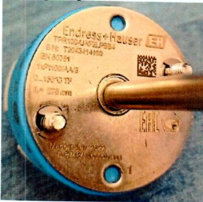
в) Термопреобразователь сопротивления TPR100 № T2043414180 в комплекте с преобразователем температуры измерительным iTEMP TMT82 № T204281426C
