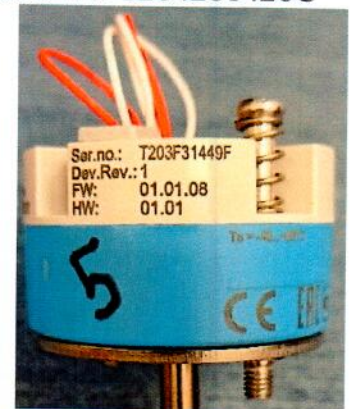
г) Термопреобразователь сопротивления TS111 № T20401143E5 в комплекте с преобразователем температуры измерительным iTEMP TMT71 № T203F31449F
