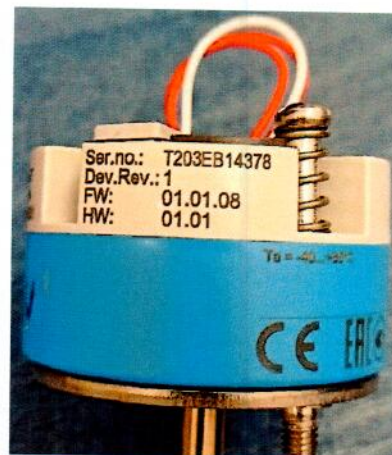
а) Термопреобразователь сопротивления TS111 № T20400143E5 в комплекте с преобразователем температуры измерительным iTEMP TMT72 № T203EB14378
