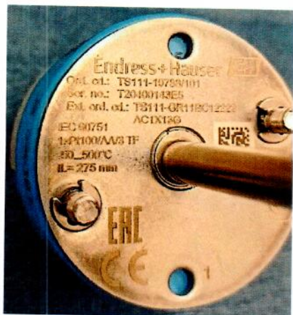
а) Термопреобразователь сопротивления TS111 № T20400143E5 в комплекте с преобразователем температуры измерительным iTEMP TMT72 № T203EB14378
