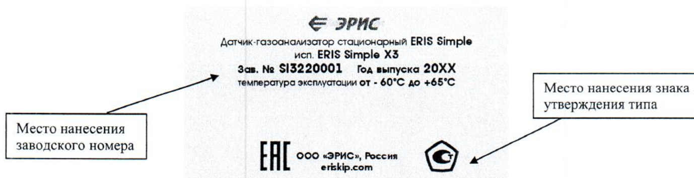
Рисунок 5 – Идентификационная табличка датчиков-газоанализаторов
