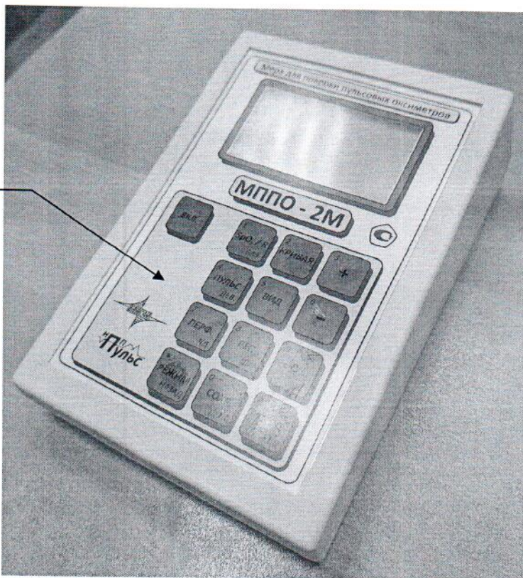
Рисунок 2.1 – Схема (рисунок) с указанием места для нанесения знака поверки
