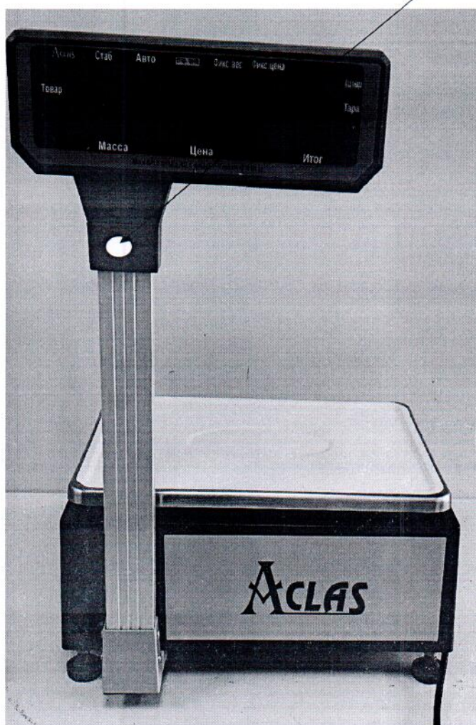
Рисунок 2.1 – Место нанесения знака поверки весов в виде клейма-наклейки
