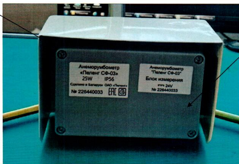
Рисунок 2 – Схема с указанием места для нанесения знака поверки средств измерений и пломбировки от несанкционированного доступа
