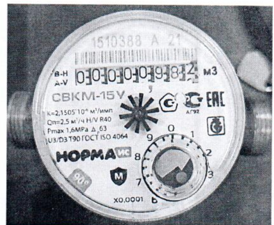
Рисунок 1.12 – Фотографии маркировки счетчиков холодной и горячей воды крыльчатых НОРМА СВКМ, НОРМА СВКС (изображение носит иллюстративный характер)
